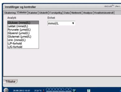
**MERK!** L/P-forholdet og L/G-forholdet har ingen enhet. For ytterligere informasjon, se Teknisk manual
