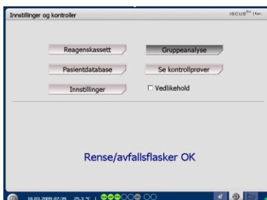
Berør første ampulleposisjon i samlesekvensen (kontroller at pilikonet inneholder en grønn pil mot høyre).
